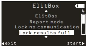
启用**锁止结果已满选项**保存各个结果：一旦启用这个选项，如果 ELITBOX / ELIKEY 没有接收到 25 个结果（最高上限），Delta 扳手自动锁止。
