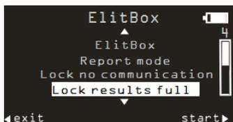
L'option **Verrouillage résultats complet** est activée pour enregistrer chaque résultat : une fois cette option activée, la clé Delta Wrench est automatiquement verrouillée si 25 résultats (maximum) ne sont pas reçus par ELITBOX / ELIKEY.
