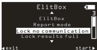
L'option **Verrouillage aucune communication** est activée pour enregistrer chaque résultat : une fois cette option activée, la clé Delta Wrench est automatiquement verrouillée quand elle se trouve hors de portée de la couverture du réseau. Dans ce cas, aucun serrage n'est autorisé.
