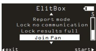
Normalement, si la clé Delta Wrench n'est pas encore connectée, toutes les 60 secondes, elle essaie de se connecter automatiquement au meilleur réseau disponible (une fois que cette fonction est déverrouillée sur ELITBOX / ELITKEY).
