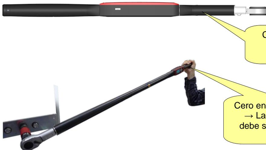
Al término del proceso de puesta a cero aparecerá el mensaje OK para indicar que se ha completado el proceso; en caso de error durante la puesta a cero, aparecerá un mensaje de "Error en el par" o "Error en la puesta a cero del giroscopio" al intentar ejecutar un apriete.
