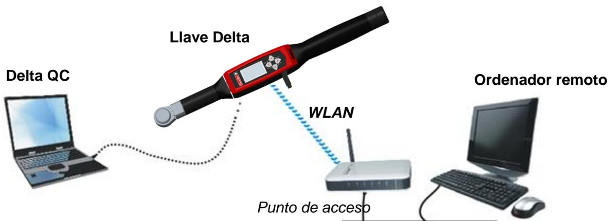
El Protocolo abierto permite a un dispositivo remoto comunicarse con la llave Delta mediante aplicaciones personalizadas.
