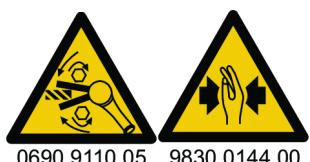
Procéder à un contrôle du sens de rotation de l'outil avant de démarrer ! Un démarrage dans un sens de rotation inattendu peut provoquer des accidents corporels ou des dégâts matériels.
