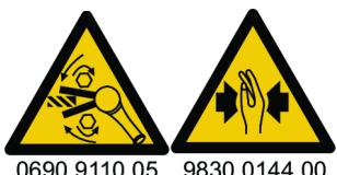
Eseguire un controllo della direzione di rotazione dell'utensile prima dell'avvio! Un avvio in una direzione di rotazione imprevista può causare lesioni o danni.
