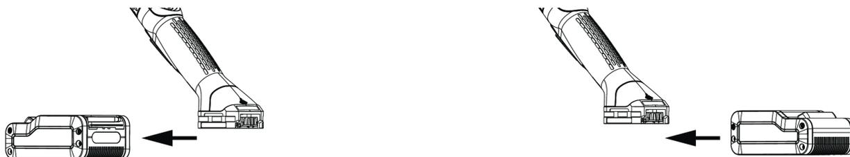
Inserte la batería en la parte delantera o trasera de la herramienta hasta que oiga claramente un sonido de bloqueo.
