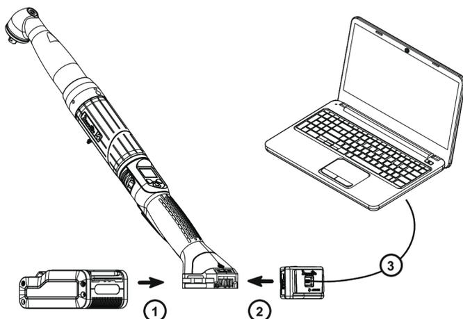
Inserire una batteria nell'utensile.
