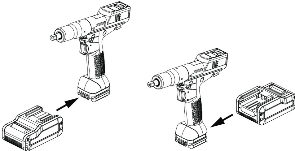
Führen Sie den Akkusatz von vorn oder hinten in das Werkzeug ein, bis ein deutliches Verschlussgeräusch zu hören ist.
