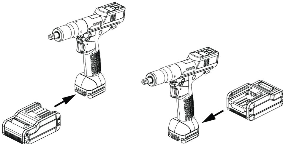
Inserte la batería en la parte delantera o trasera de la herramienta hasta que oiga claramente un sonido de bloqueo. Si no hay interruptor de encendido/apagado: la herramienta está preparada para funcionar en cuanto se monta una batería.
