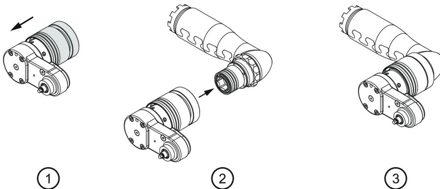
Verbinden Sie ein Zubehörteil mit dem Schnellverschluss-Ausgang und weisen Sie ihm ein Pset zu.
