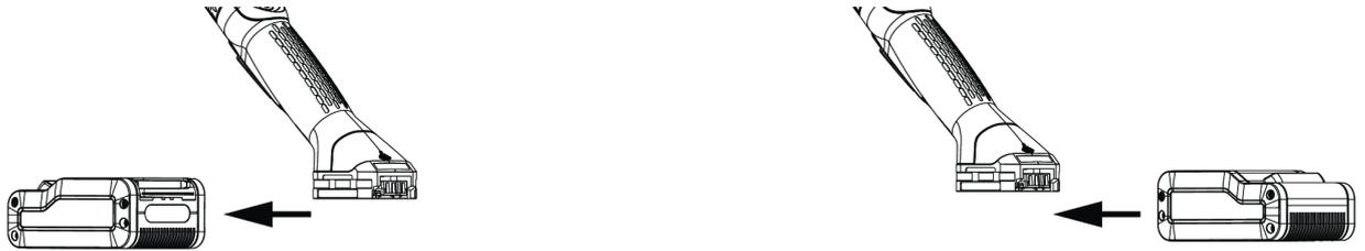
Insérer le bloc-batterie à l'avant ou à l'arrière de l'outil jusqu'à ce qu'un bruit de blocage soit clairement entendu.
