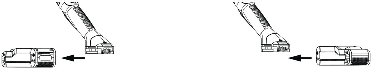
Führen Sie den Akkusatz von vorn oder hinten in das Werkzeug ein, bis ein deutliches Verschlussgeräusch zu hören ist.
