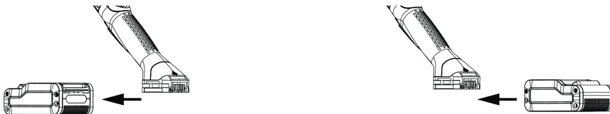
Inserire la batteria sulla parte anteriore o posteriore dell'utensile fino a quando non viene emesso uno scatto.
