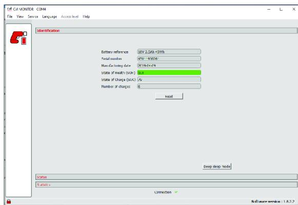
ⓘ La marca verde en la parte inferior de la pantalla indica que la batería está correctamente conectada.
