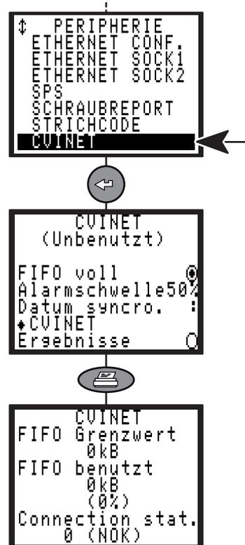
Die CVINET Software kann zur Wiederherstellung der Schraubergergebnisse am PC via Ethernet eingesetzt werden.
