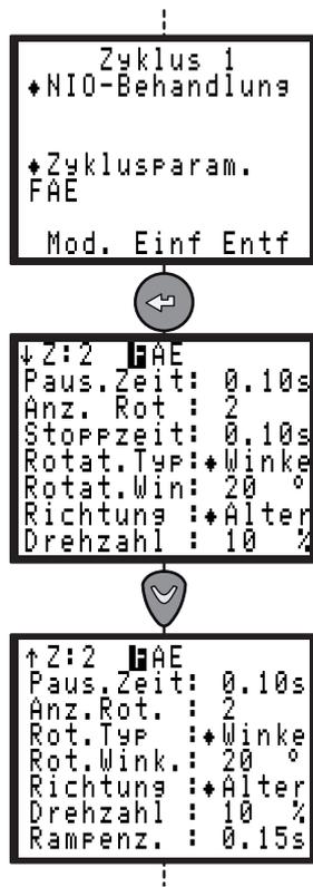
Die Maximalzeit wird bei der Fädelstufe nur angezeigt, da sie automatisch mit der Anzahl Rotationen multipliziert mit Rotationszeit + Stoppzeit übereinstimmt.
