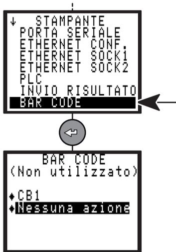
Il lettore codice a barre permette di selezionare automaticamente uno dei cicli previamente programmati nel controllore.
