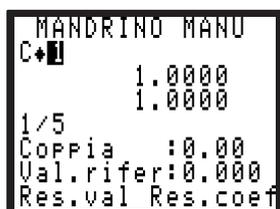
Questo menu è usato per calcolare e applicare il coefficiente di correzione al valore di coppia del ciclo scelto.
