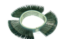
1 četkasti remen 23 mm, ravan, kaljeni vrh. Koristi se za uklanjanje boje, premaza (npr. brtvila) i hrđe bez učinka pjeskarenja.
